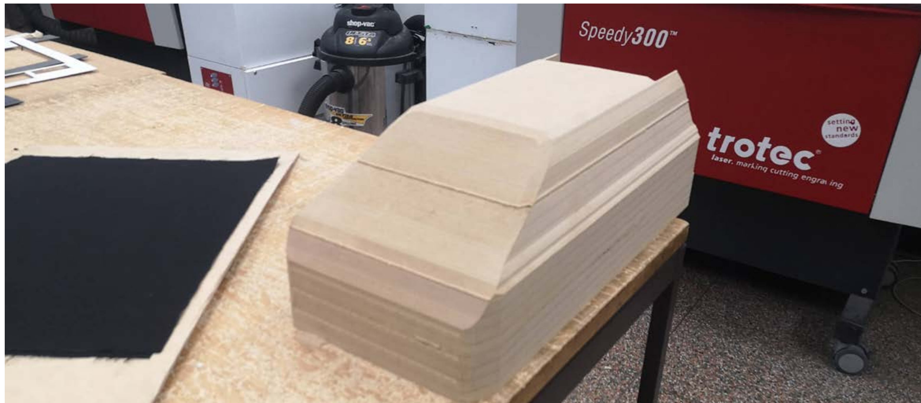
Structure en MDF pour une maquette en argile
