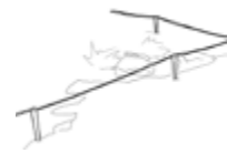
Câbles de délimitation avec ancrages
