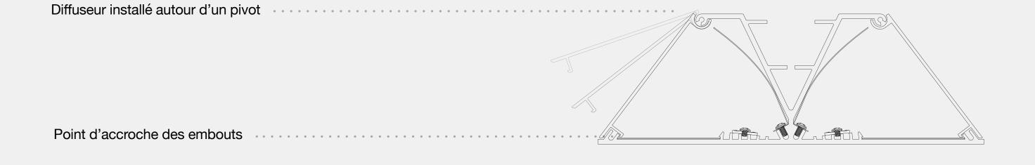
Joints d'étanchéité bloquant toutes les possibles entrées d'eau
